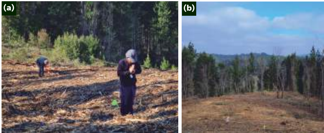
Figura 21: (a). Delimitación de diagonales con distanciómetro y banderolas, (b) Marcaje de clústers en terreno mediante el uso de banderolas.
