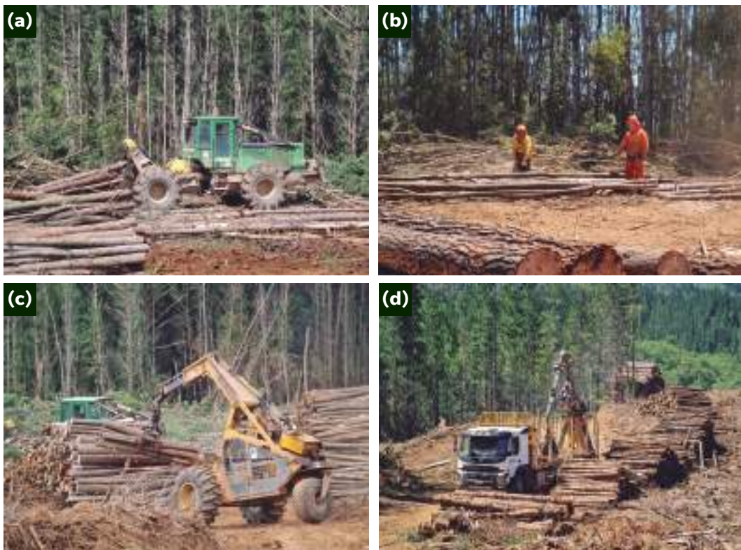
Figura 16: (a) Fotografía de arrastre de especies exóticas cosechadas con skidder, (b) Dimensionadas por motosierristas, (c) Clasificación y acopio por un trineumático, (d) Retiro de madera en camiones autocargantes en un sitio a restaurar.
